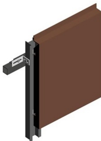
شکل ۸-۴- نمونه‌ای از روش اجرای هوک
