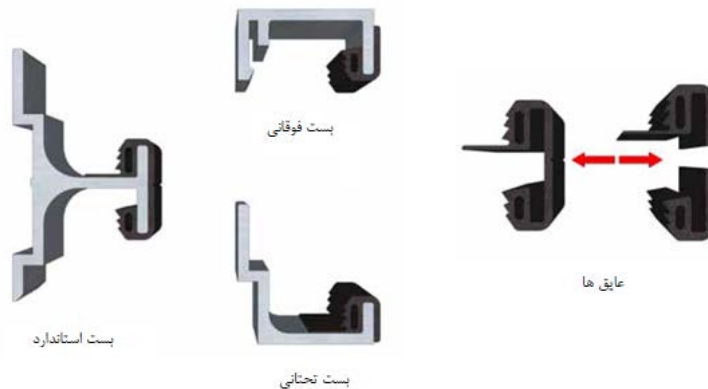
شکل ۷-۵- نصب درزپوش بر روی مهارها
