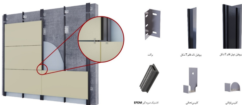
شکل ۷-۹- اجزای سیستم نصب نمایان
