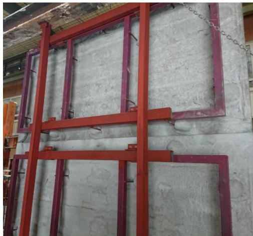
شکل ۱۱-۱۳- نمونه‌هایی از لایه پیوندی و مهارهای انعطاف‌پذیر
