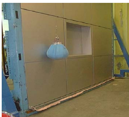
شکل ۳-۵- آزمایش ضربه جسم نرم سنگین روی نما
